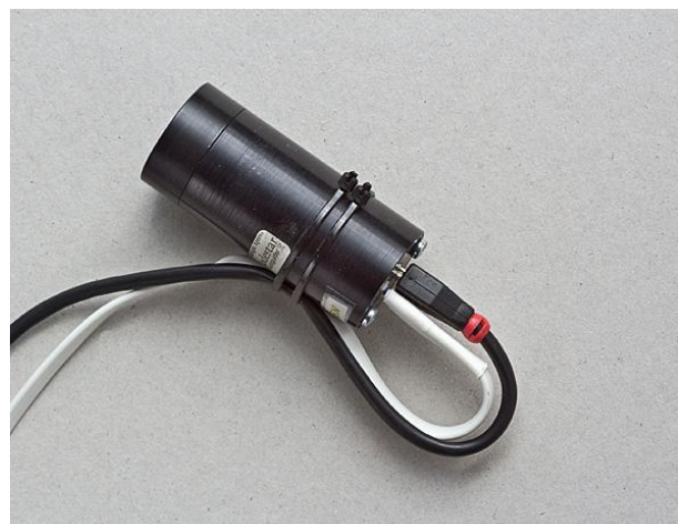
Bild 4: Die Kamera Starlight Xpress Lodestar. Das weiße Steuerkabel bricht leicht am Stecker ab. Deswegen die stabile Zugentlastung.
